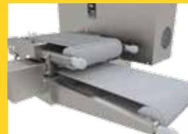
REGULACIÓN DEL ESPESOR DE FILET
